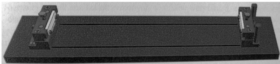
Ryc. 3. Zaciski pomiarowe do mocowania tekstylnych linii przesyłowych
