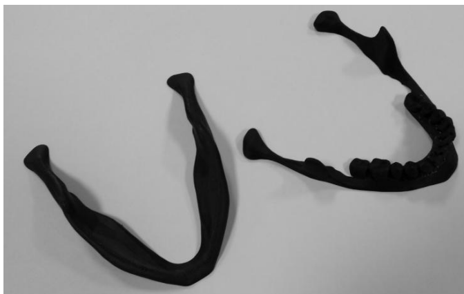
Ryc. 1. Model żuchwy wykonany z ABS
