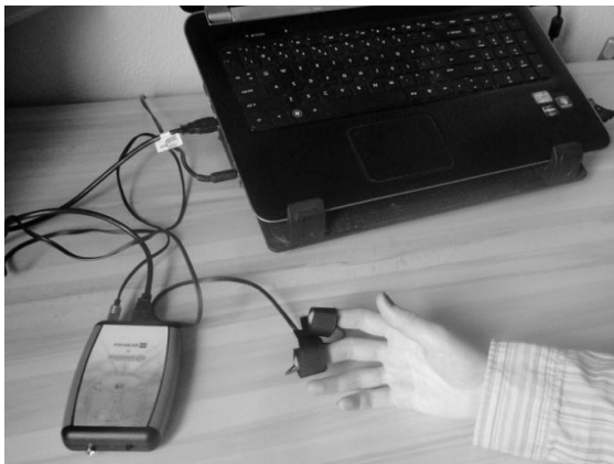
Fot. 1: Urządzenia niezbędne do przeprowadzenia pomiaru oraz treningu EDA biofeedback: głowica, elektrody, kabel USB, komputer
